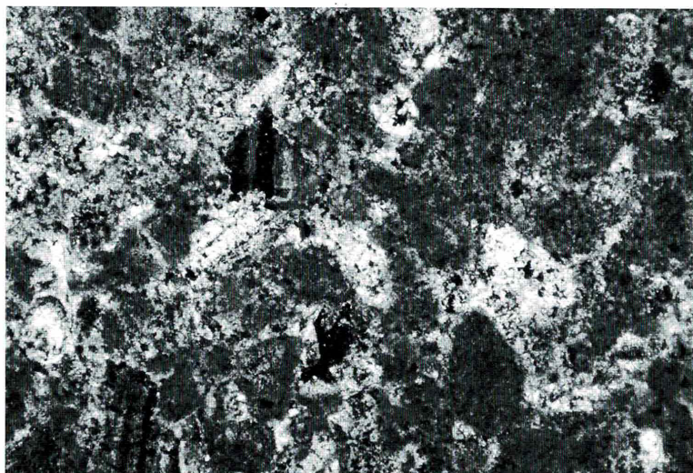
Fig. 30 - Campione A: tessera bianca dal pavimento in signino, vano 3 dell'edificio presillano.
